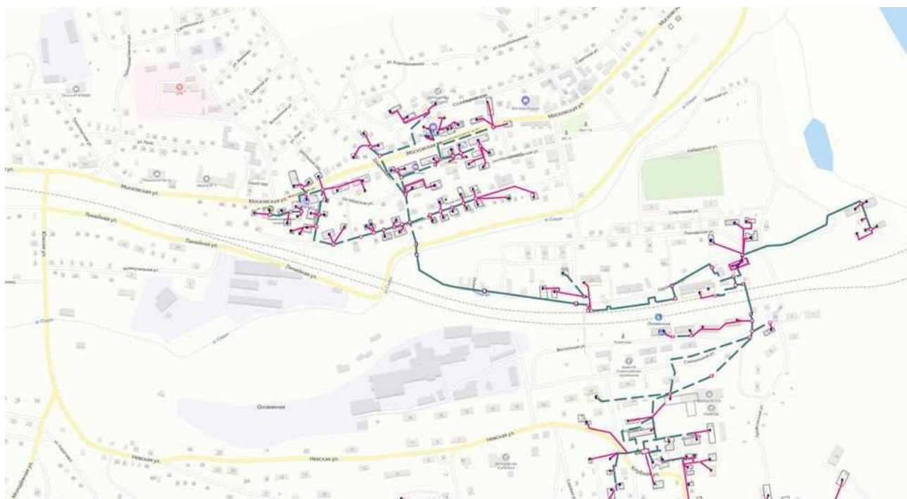
Рис.2.2 – Схема теплоснабжения от котельной Пионерской
