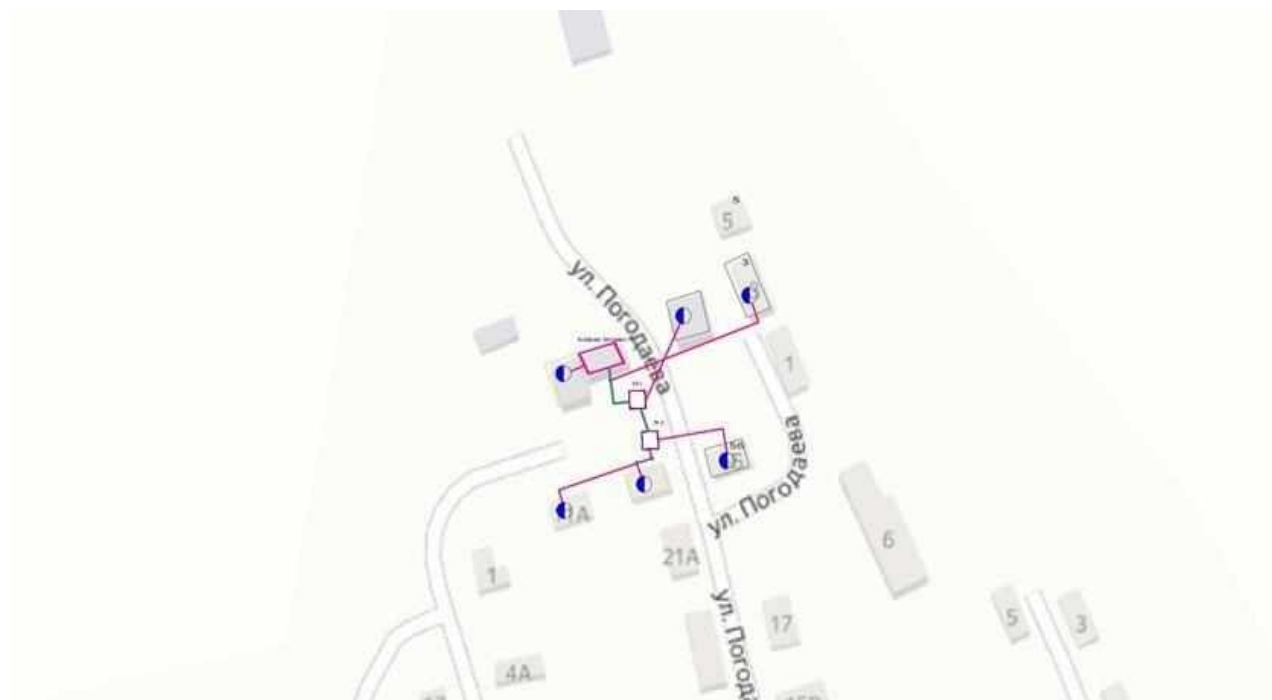
Рис.2.6. – Схема теплоснабжения от котельной Погодаева УП
