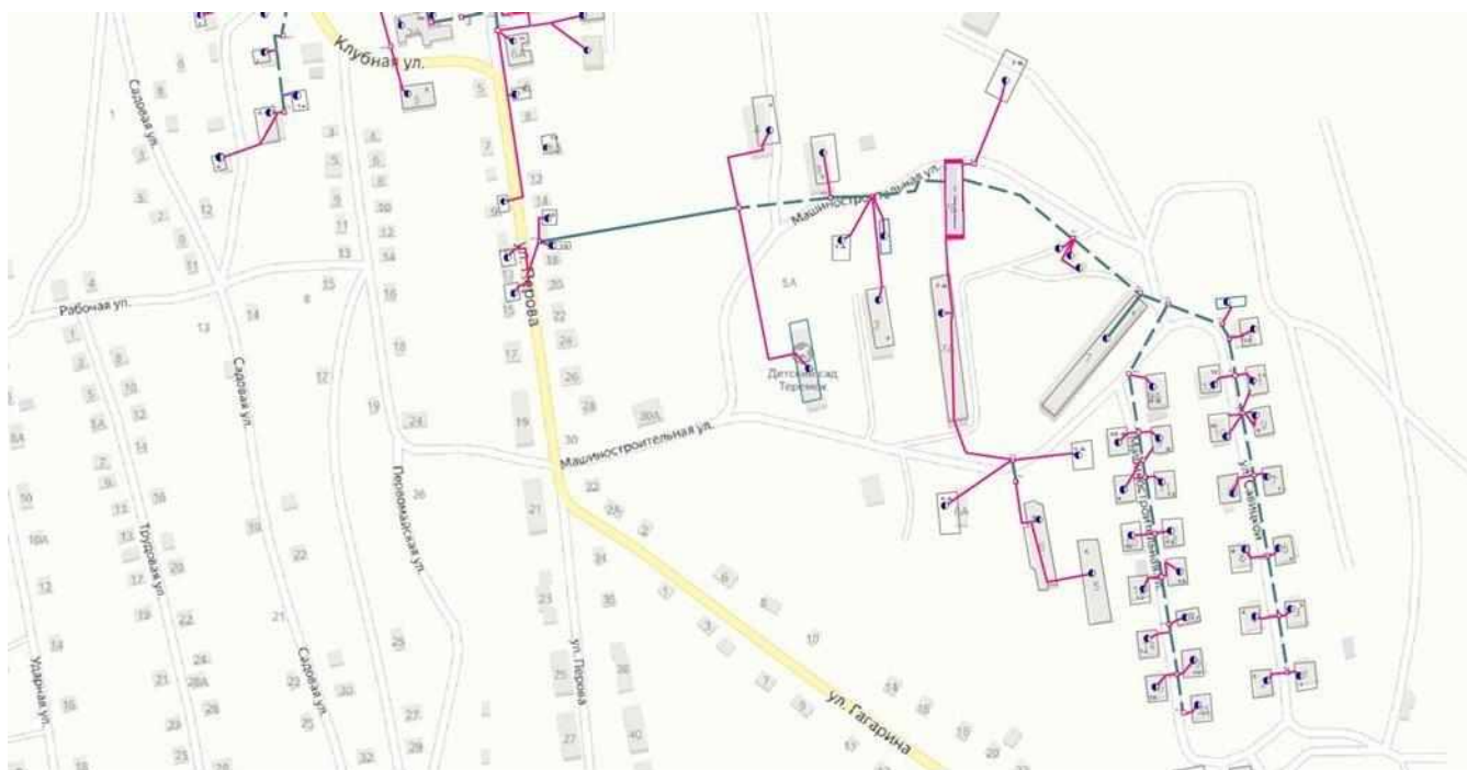
Рис.2.3. – Схема теплоснабжения от котельной Машиностроительная
