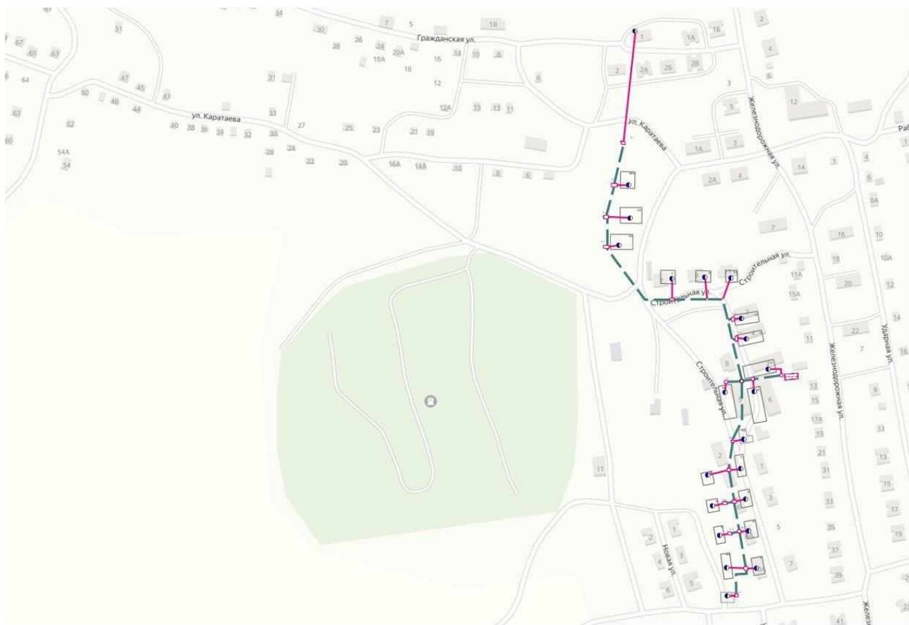
Рис2.4. – Схема теплоснабжения от котельной ПМК
