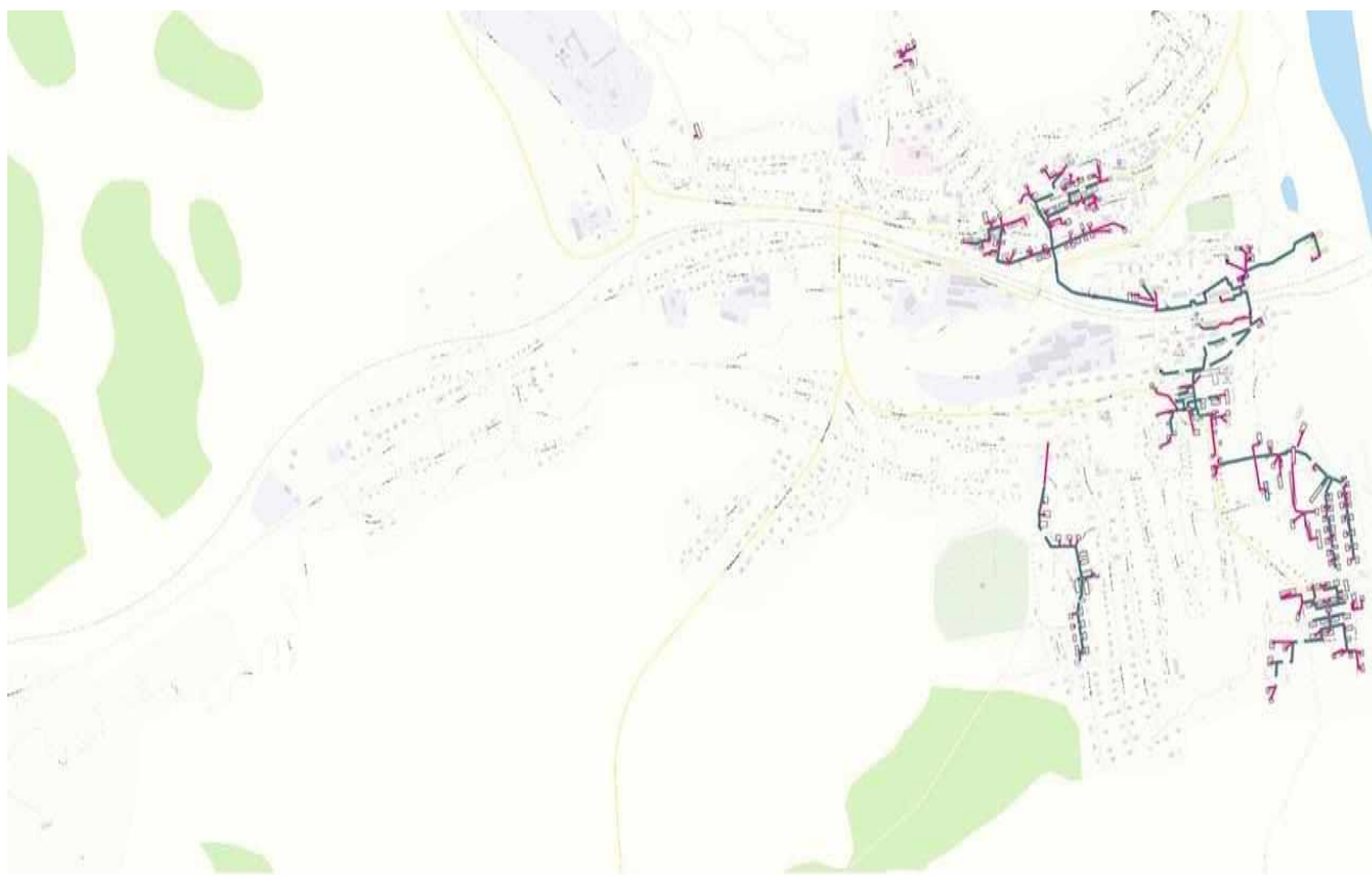
Рис.2.1. – Существующая схема теплоснабжения п.г.т. Оловянная
